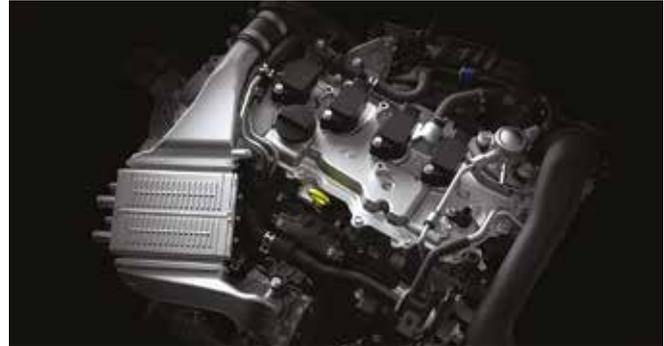
développe 116 ch et un couple constant de 185 Nm sur la plage de 1 500 à 4 000 tr/min. Il emmène le Toyota C-HR de 0 à 100 km/h en 10,9 secondes et lui autorise une vitesse de pointe de 190 km/h. Pour autant, la consommation et les émissions restent très contenues avec 5,8 l/100 km en cycle mixte et seulement 135 g de CO<sub>2</sub> au km (5,5 l/100 km et 125 g/km de CO<sub>2</sub> sur certains marchés)
