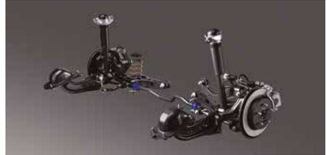
spécialement pour le modèle. L'axe de rotation de la butée est notamment étudié pour réduire radicalement les frottements de la direction, au profit de sa douceur et de sa précision. Et pour obtenir la résistance au roulis d'une berline, la barre stabilisatrice de gros diamètre est directement reliée à la jambe par l'intermédiaire d'une biellette.
